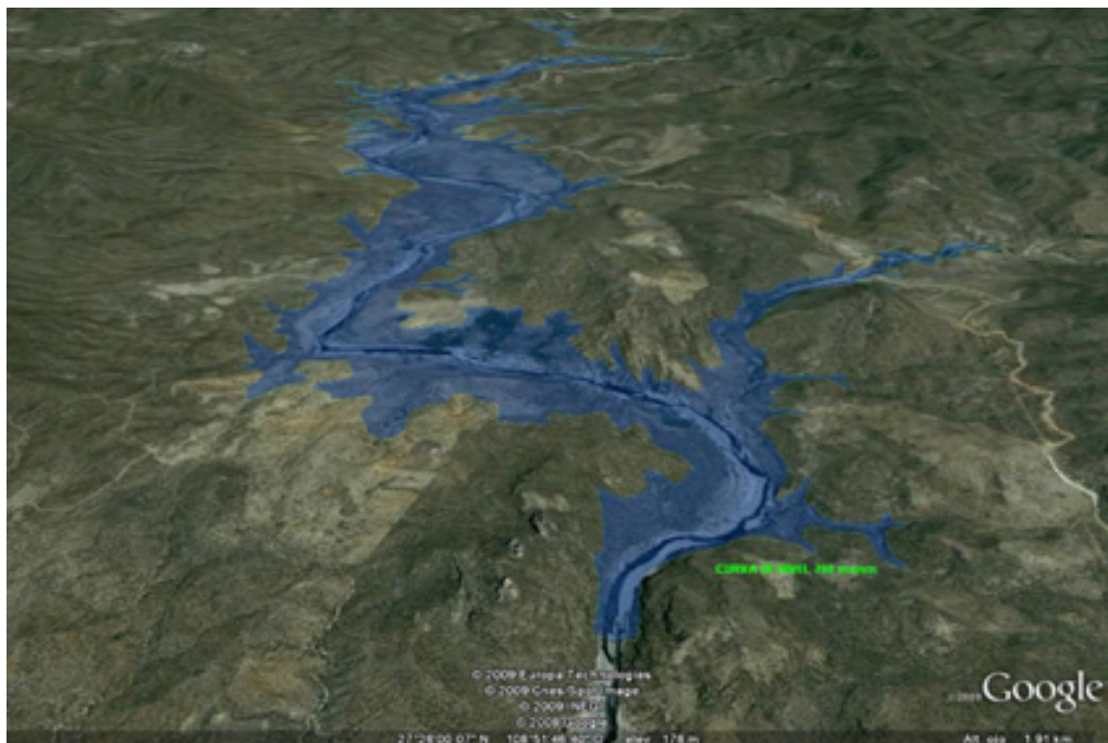
Figura IV.35. Imagen satelital que muestra la superficie a inundar para una cortina de 35 m de altura.
