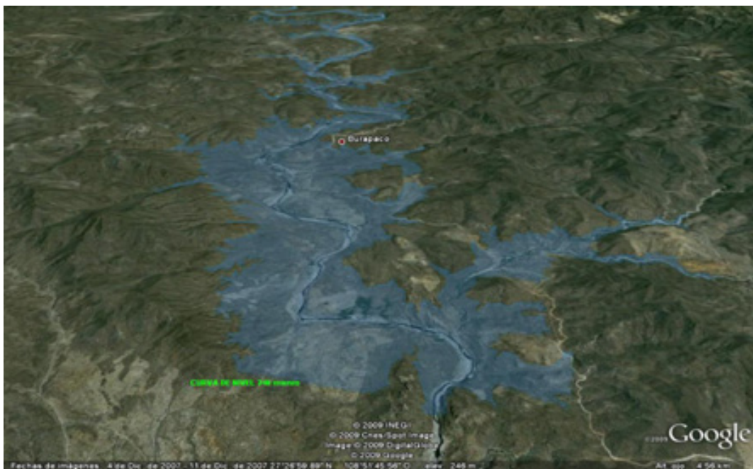
Figura IV.37. Imagen satelital que muestra la superficie a inundar para una cortina de 75 m de altura.
