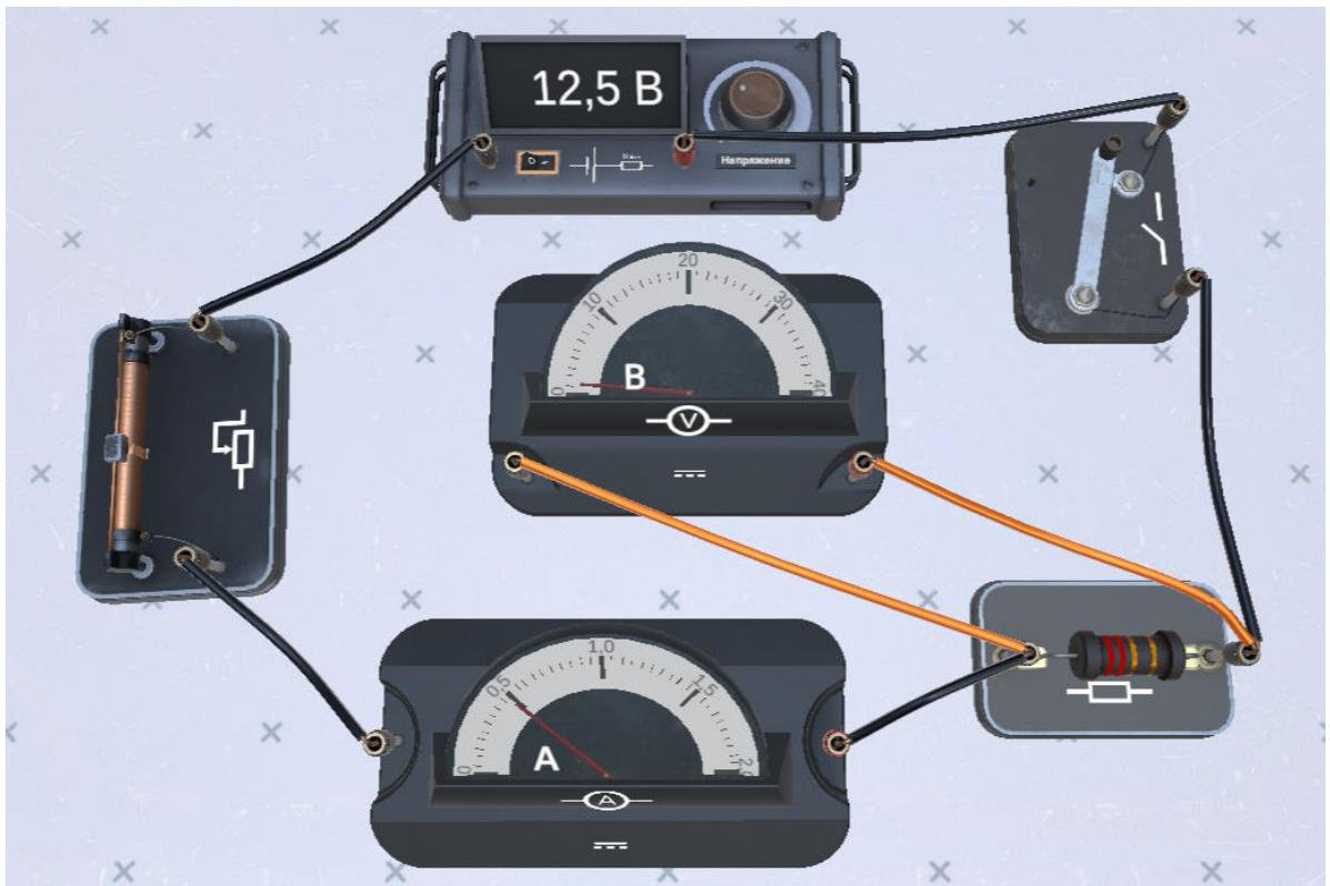
Рис. 4 Электрическая цепь для закона Ома
