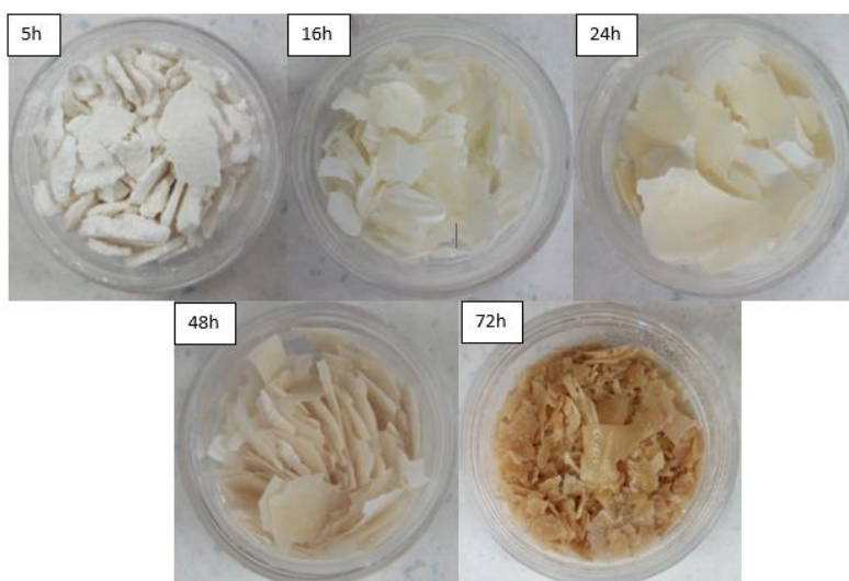
Figura 4.2.-PCL obtenida utilizando \text{Sn}(\text{Oct})_2 .
