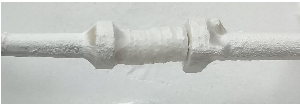
Figura 3.20.-Electrohilado de PCL sintetizada con NaH sobre los andamios impresos.
