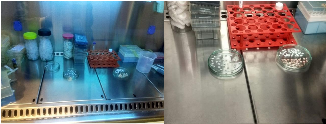
Figura 3.22.-Andamios en esterilización por luz U.V.
