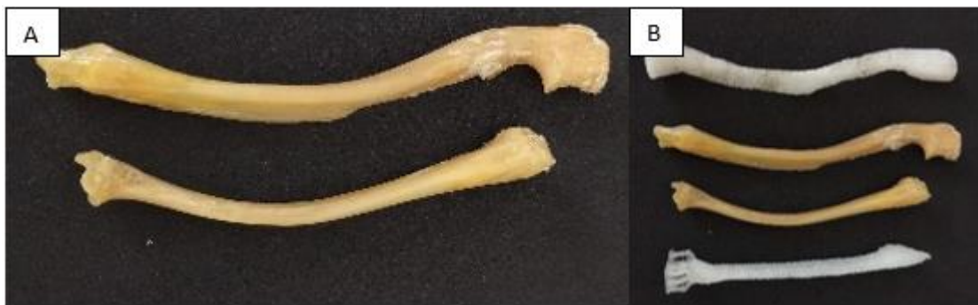
Figura B 3.-A) Huesos de tibia y peroné, B) Huesos reales e impresos.
