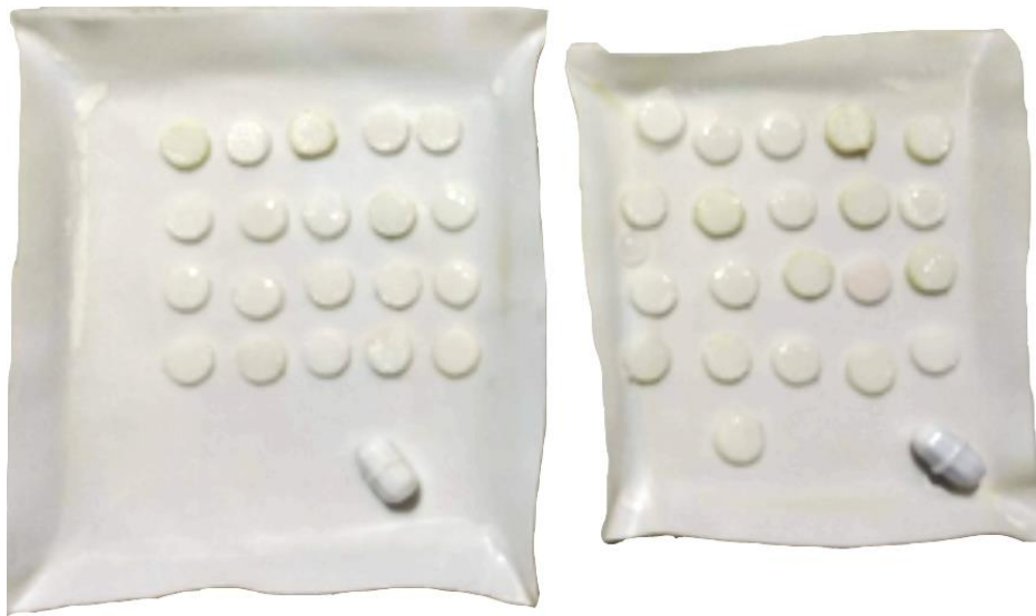
Figura 3.7.-Andamios impresos utilizando PCL como material de impresión.
