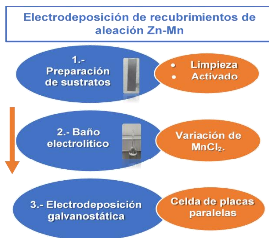
Figura 1.1.1 Diagrama del proceso de electrodeposición aleación de Zn-Mn sobre sustratos de acero.
