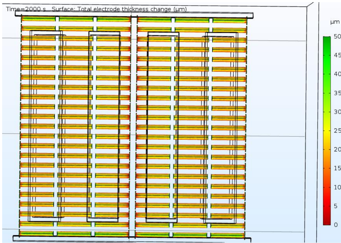
Figura 8-17. Se muestra mediante un cambio de colores tipo semáforo el espesor de recubrimiento sobre los cátodos.
