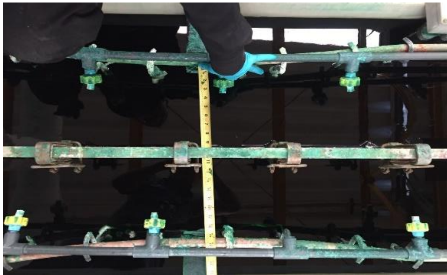
Figura 4-8. Fotografía de la celda Doxsteel donde se muestra la distribución anódica catódica, utilizada en 2018-2019.
