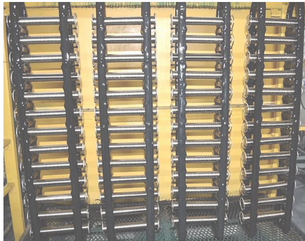
Figura 4-3. Colgado típico de piezas en un bastidor para electrodeposición con contacto eléctrico por gravedad.
