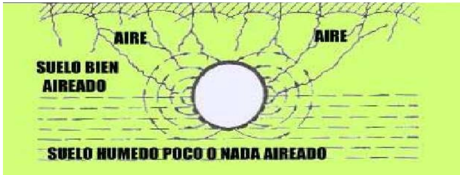
Pilas de corrosión por diferencias de humedad y aireación
