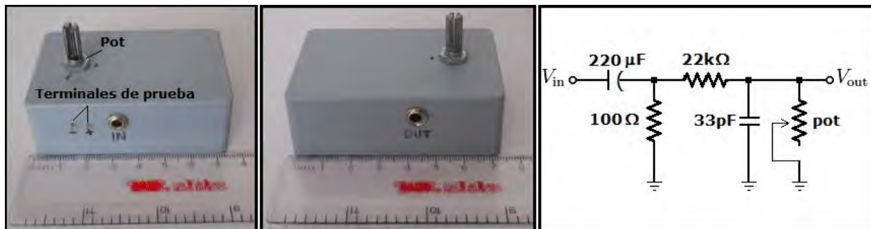
Figura 5.8: Componente (H), las terminales de prueba están en paralelo con la entrada y se utilizan para evaluar, con un osciloscopio, el nivel de offset a la entrada.
