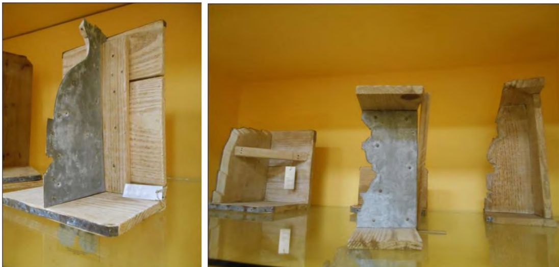
Figura 5 – Nas duas imagens: Moldes para “correr” as massas de estuque, no Banco de Materiais da Câmara Municipal da cidade do Porto, em Portugal. Fonte: Acervo pessoal do autor.
