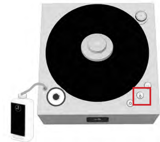
Abb. 11: Entleeren des Vorratsbehälters
