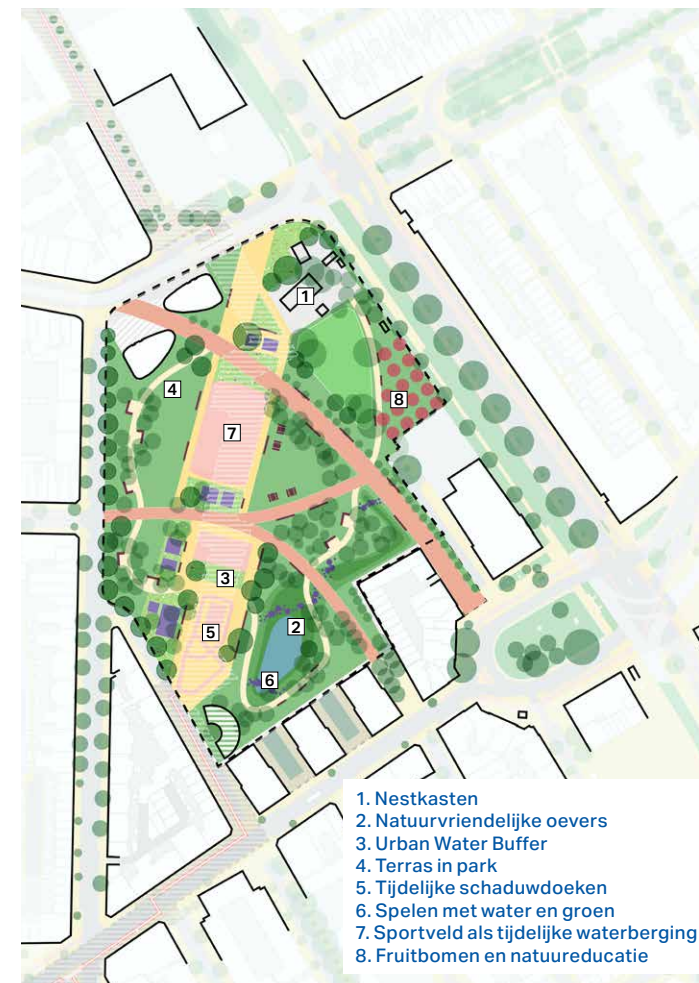
Ontwerp voor wijkpark Transvaal, met de aanleg van het warmtenet (dat tussen de witte stippellijnen onder de sportvelden doorloopt) als aanleiding voor ontwikkeling en als basis voor het ontwerp.
