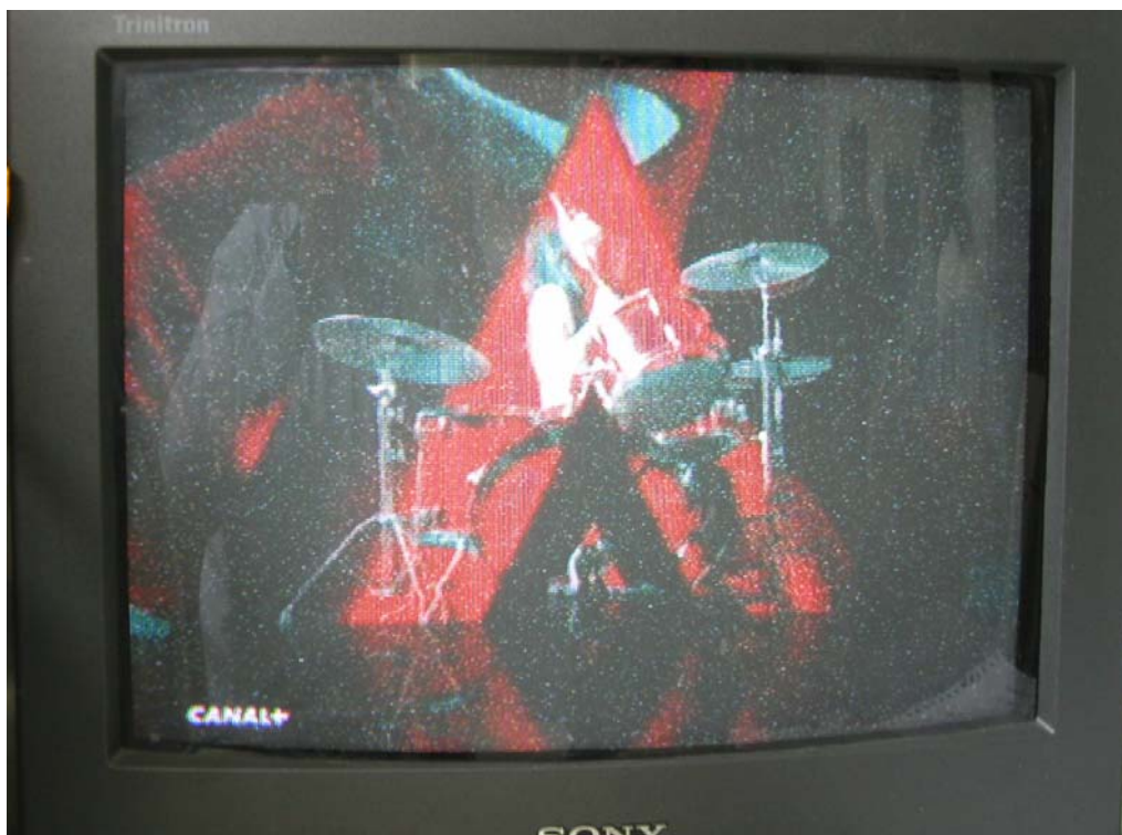
Figura 21. Imagen de un canal analógico con efecto de “nieve” producido por intermodulación. Corresponde a una relación señal/intermodulación de 36 dB.
