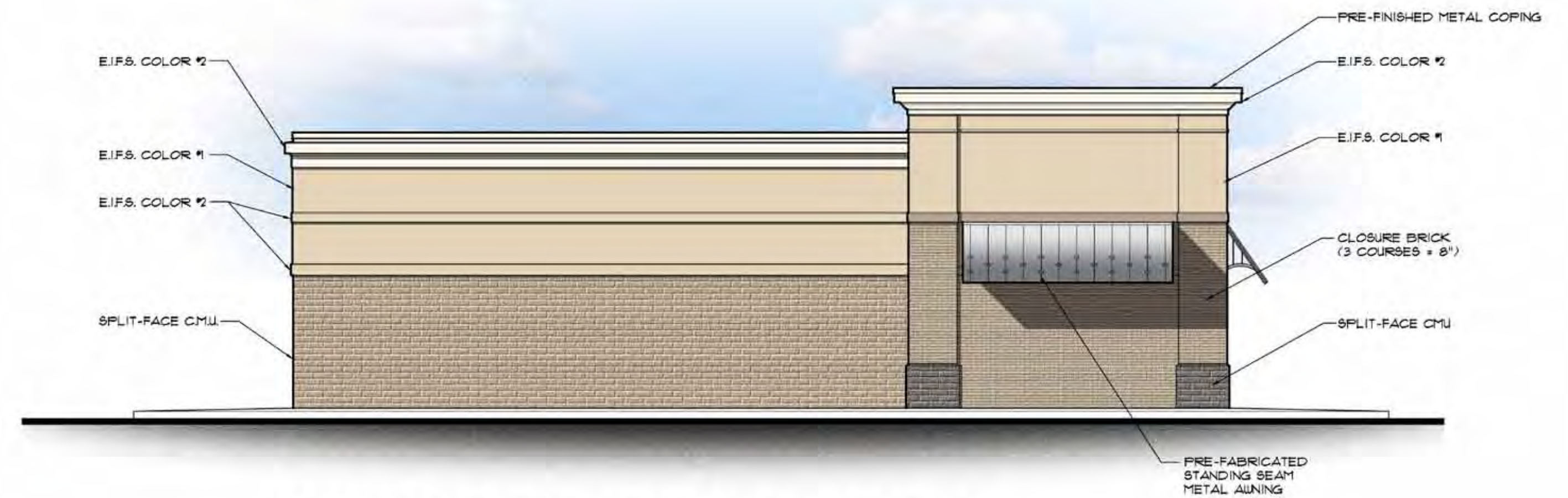
(D) LEFT SIDE ELEVATION AREA A SCALE: 1/8" = 1'-0"
