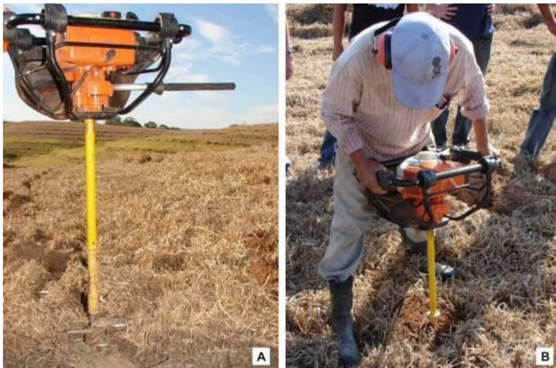
Figura 49 - Aspecto de uma moto-coveadora (A) e abertura de cova com moto-coveadora (B).
