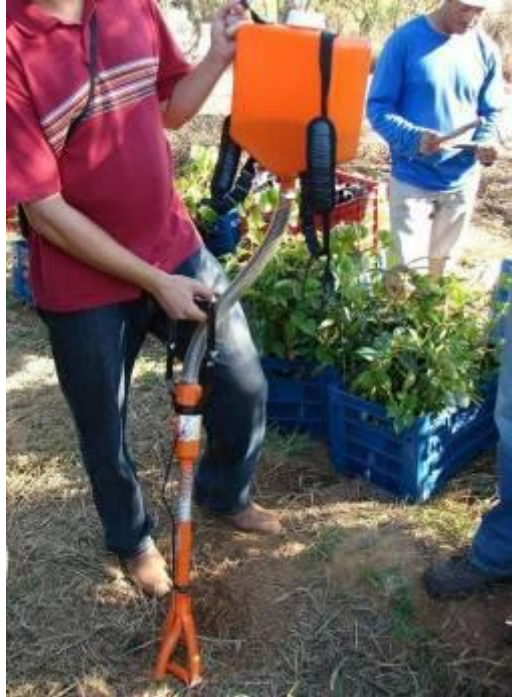
Figura 45 - Equipamento costal para aplicação de iscas a granel.
