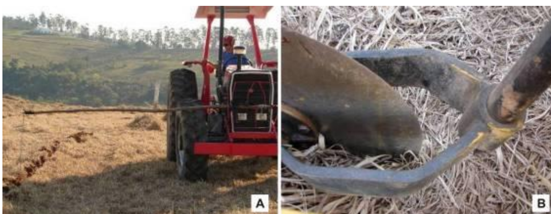
Figura 51 - Uso de um pedaço de uma vara de madeira “bigode” com uma corrente em sua extremidade para a orientação da subsolagem em relação à linha adjacente (A) e disco de corte do subsolador cortando a palhada já seca (B).
