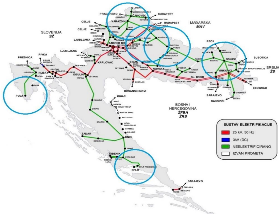
Slika 1. Lokacije stabilnih električnih priključaka za punjenje baterija
