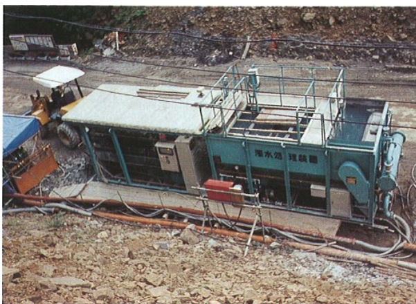
図 14-5-5 汚濁処理施設の例
