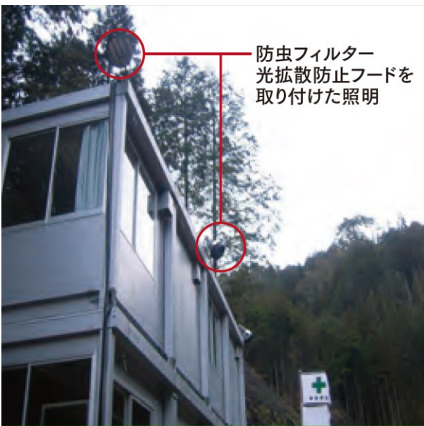
図 14-5-7 照明の漏れ出しの抑制の例
