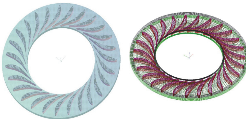
Рис. 3. Модель, выполненная в ANSYS BladeModeler
