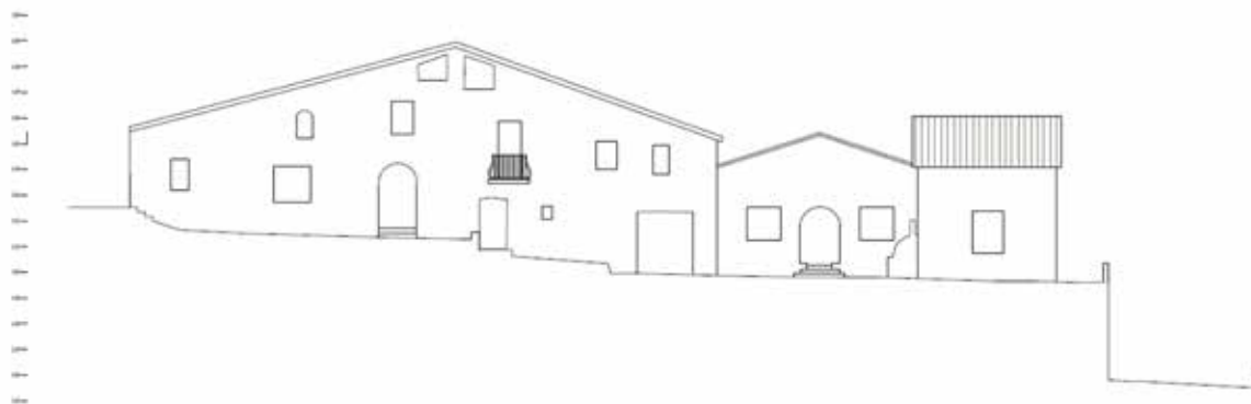
imatge 2 - Alçat sud de la Masia: a l'esquerra es troba el cos principal històric de l'edifici i a la dreta el celler construït al principi del segle XX i l'annex de l'habitatge dels anys quaranta.
