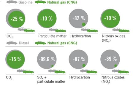
Source: own graphicbased on study "CNG und LPG - Potentiale dieser Energieträger auf dem Weg zu einer nachhaltigen Energieversorgung des Straßenverkehrs", 2013 / basis: passenger car (Euro 5) CNG has significant emission benefits compared with gasoline and diesel (© erdgas mobil)
