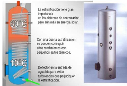
Se recomienda el uso de acumuladores verticales, aunque a veces por problemas de espacio es necesario el empleo de acumuladores horizontales, especialmente en sistemas compactos por termosifón. Para alcanzar una óptima estratificación de la temperatura en el interior del depósito solar, además de que el depósito o acumulador vertical cuente con un factor de forma mínimo de 2 es imprescindible una óptima conexión de tuberías y entrada de los fluidos en el interior del depósito.
