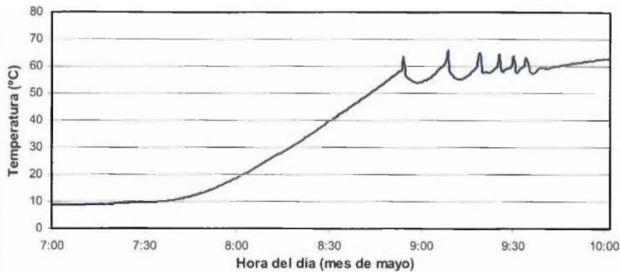
Para entender el comportamiento del fluido primario en el captador solar cuando la bomba está parada, debe tenerse en cuenta que al calentarse el fluido, disminuye su densidad y el fluido más caliente se acumula en la parte superior del captador solar, concretamente en el tubo colector superior: es aquí donde se debe situar la sonda de control que mide la temperatura del captador solar.
