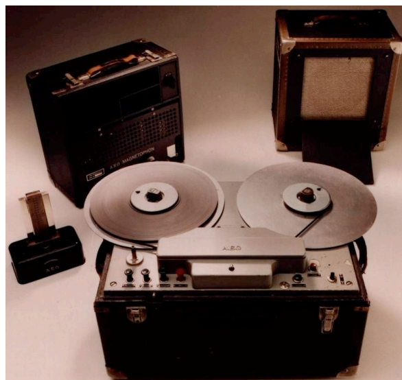
Abb. 23: Links: AEG Magnetophon K1 aus dem öffentlichen Geschäftsbericht 1935. - Rechts: AEG Magnetophon K1 mit kleinem Mikrophon, Verstärker und Lautsprecher. - Online Ressource http://www2.magnetbandmuseum.info/aeg-k1-bis-k3.html - (links) http://www2.magnetbandmuseum.info/uploads/pics/aeg-magnetophon-K1-urzustand-1_02.jpg - (rechts) http://www2.magnetbandmuseum.info/uploads/pics/aeg-magnetophon-K1-1935-800pix.jpg (Stand 2.10.2008)
