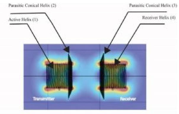
$V_{IN_{LOAD}} = Z_{11} \cdot I_1 + Z_{12} \cdot I_2 + Z_{13} \cdot I_3 + Z_L \cdot I_4$
