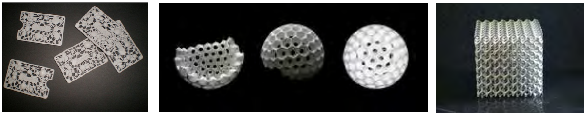
Figure I.1 : Exemples de pièces réalisées à partir de la technique de frittage laser sur de la poudre de polyamide PA6 et PA12.
