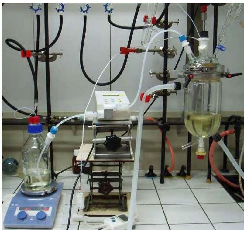
Figure T6 : Montage expérimental – procédé semi-batch.
