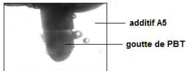
Figure 4.21 : Interface entre une goutte de PBT et l'additif A5 à T = 240^\circ\text{C} .
