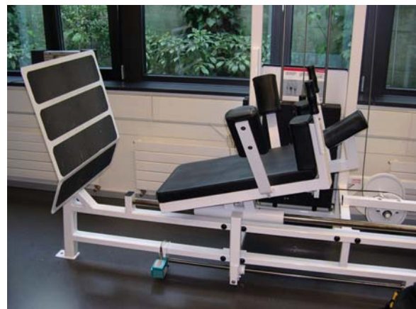
Figure 5.45 Appareil d'entraînement leg presse avec table inclinée, cales de retenue sur les épaules et poignées de soutien.
