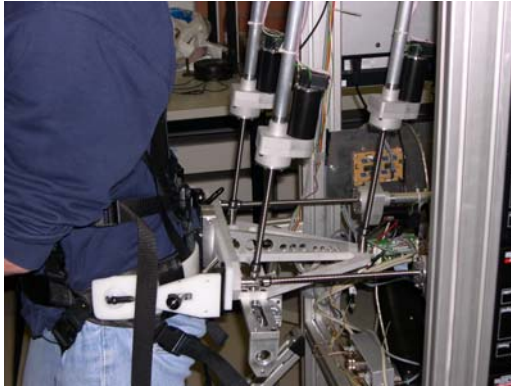
Figure 8.10 Prototype WalkTrainer™: à g.: vue de l'interface orthétique de tenue du bassin à d.: vue d'ensemble avec le treuil, le mécanisme de suspension 4DDL et le harnais avec un sujet valide (l'auteur).
