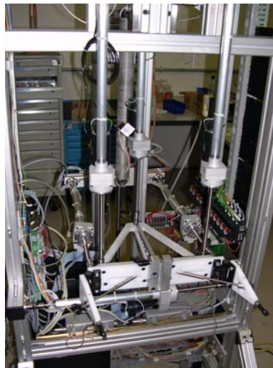
Figure 8.11 Prototype WalkTrainer™: Orthèse du bassin à g. et au m. Installation sur tapis roulant à d.
