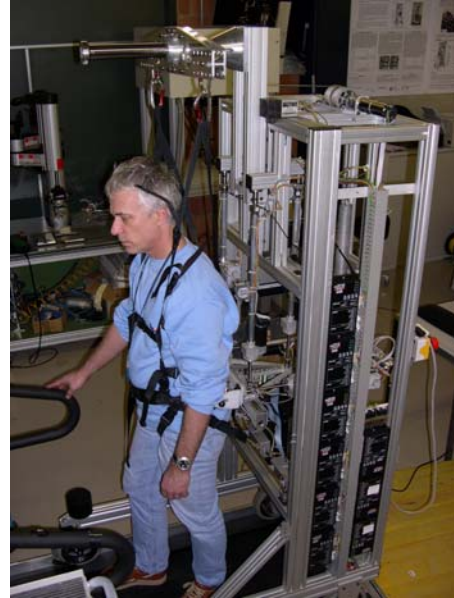
Figure 8.10 Prototype WalkTrainer™: à g.: vue de l'interface orthétique de tenue du bassin à d.: vue d'ensemble avec le treuil, le mécanisme de suspension 4DDL et le harnais avec un sujet valide (l'auteur).
