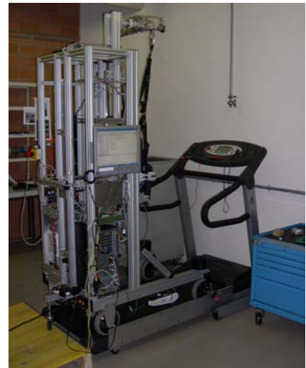
Figure 8.11 Prototype WalkTrainer™: Orthèse du bassin à g. et au m. Installation sur tapis roulant à d.
