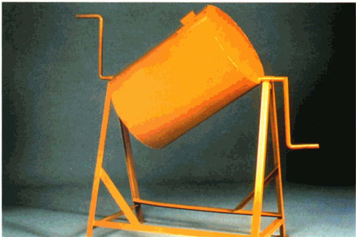
FIGURA 32. Tambor rotativo utilizado para tratamento de sementes.
