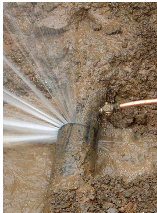
Εικόνα 4: Παράδειγμα απωλειών σε αγωγό λόγω υψηλής πίεσης (πηγή: www.nj.gov )
