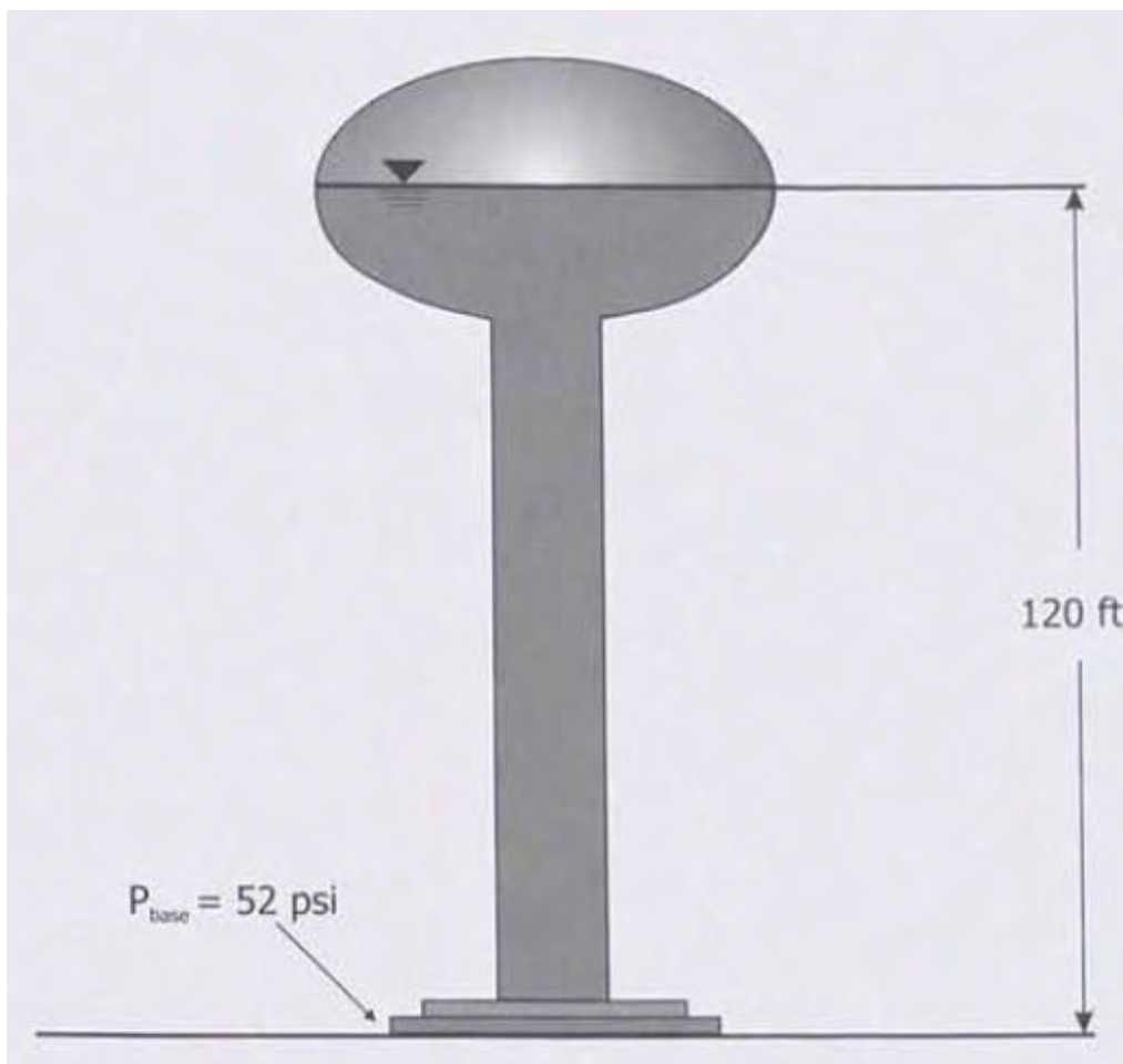
Εικόνα 25: Υδροστατική πίεση στην βάση της δεξαμενής
