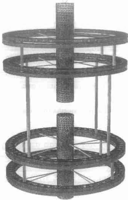
Εικόνα 73: Παραμορφωμένη (πράσινο) και απα- ραμόρφωτη (γκρί) κατάσταση πλαισίου Ilizarov (Η παραμόρφωση έχει μεγεθυνθεί 5 φορές).
