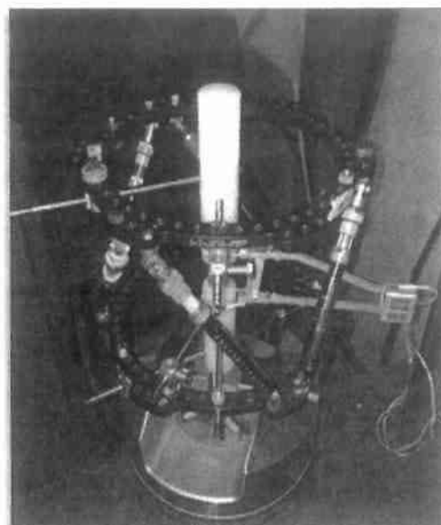
Εικόνα 76: Διάταξη πλαισίου TSF (TSF_2 στο Διάγραμμα 15). Διάμετρος δακτυλίων 180mm (κλειστού τύπου), 5 half pins διαμέτρου 6mm.
