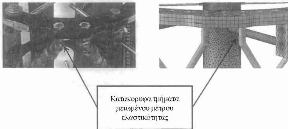
Εικόνα 63: Περιοχές μειωμένου μέτρου ελαστικότητας. Αριστερά φαίνονται τα κατακόρυφα τμήματα των τηλεσκοπικών ράβδων στην πειραματική διάταξη και δεξιά οι ίδιες περιοχές στο μοντέλο.
