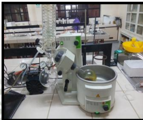
Figura 4. Material llevado al Rota-vapor donde se concentró el extracto de Achyrocline alata (Huirá huirá)
