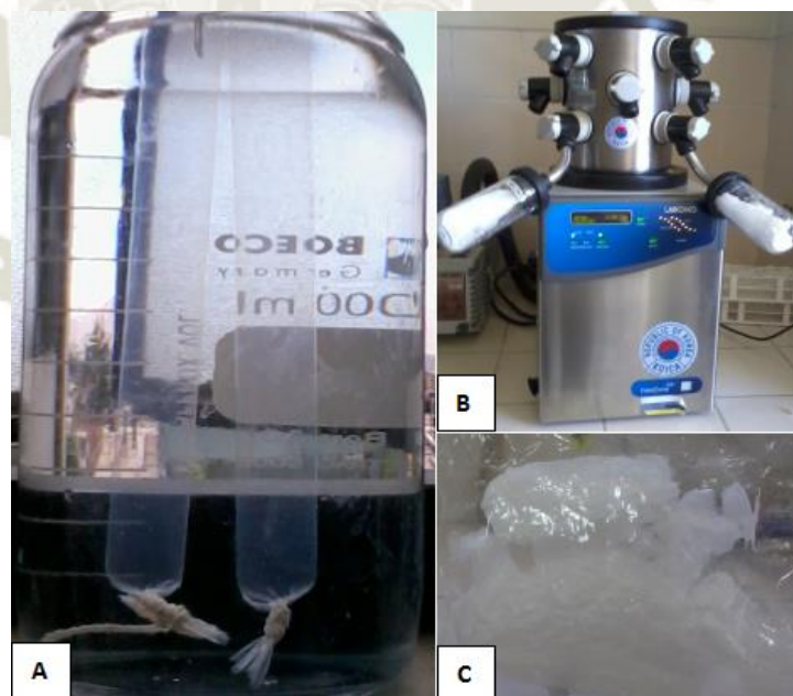
Figura 10. Diálisis de colágeno. A) Solución de colágeno en membranas de diálisis. B) Liofilizador. C) Colágeno solido liofilizado. Fuente: Propia
