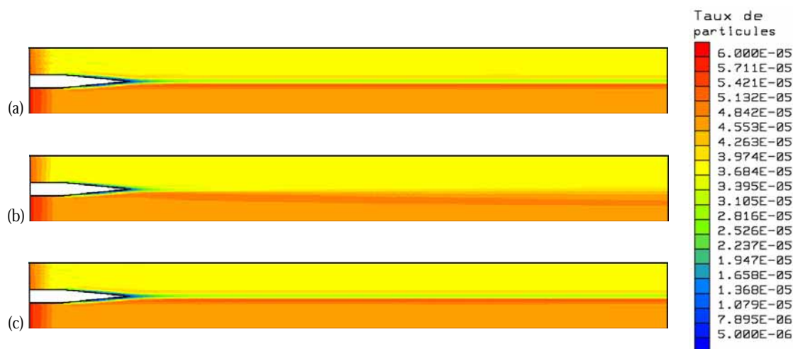
Figure 6- 26 : Calcul d'une couche de cisaillement, répartition des particules selon les modèles diphasiques, (a) Modèle de base, (b) SPPM \lambda=100 , (c) CPPM.
