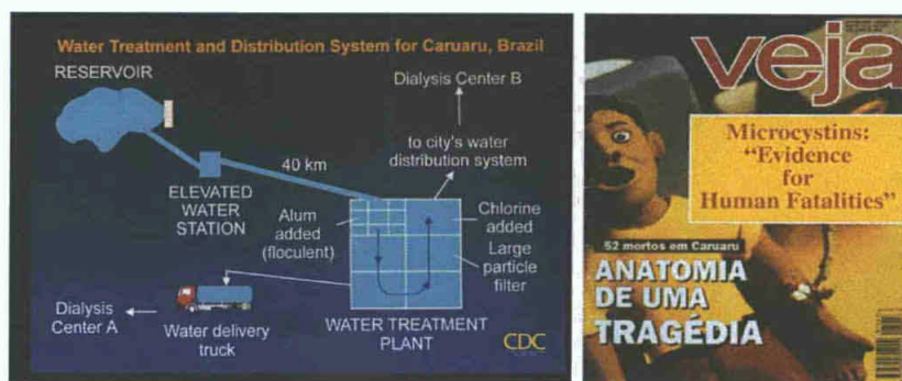
Figura 1. Sistema de tratamiento y distribución de agua en Cuaruru, Brasil (izquierda). Reporte de pacientes fallecidos por intoxicación de toxinas producidas por cianobacterias (derecha). Fuente: Curso de entrenamiento: Ensayos toxicológicos con cianobacterias aplicados a la calidad ambiental, Universidad Federal de Sao Carlos, Brasil 2009.
