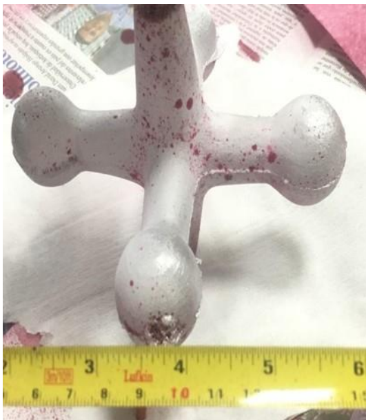
Figura 80. Método 2 – CAD, END, tintas penetrantes, escala 1:0.014, catapiz
