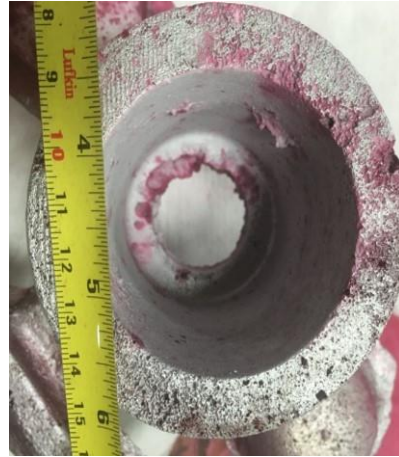
Figura 100. Método 2, END, tintas penetrantes, vista inferior, escala 1;0.011, polea
