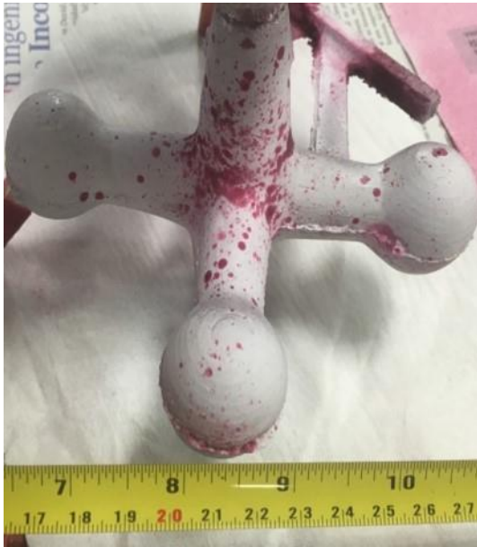
Figura 78. Método 1 – CAD, END, tintas penetrantes, escala 1:0.015, catapiz
