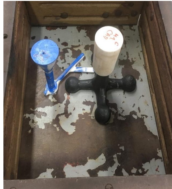
Figura 57. Modelo del componente y de los sistemas, método 1 – CAD, catapiz
