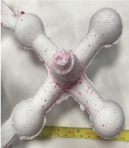
Figura 76. Método 1 – Formas, END, tintas penetrantes, escala 1:0.025, catapiz
