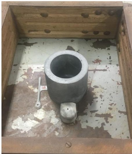
Figura 90 . Modelo del componente y sus sistemas, método 1, polea
