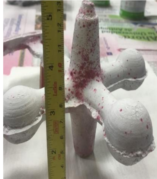
Figura 77. Método 1 – Formas, END, tintas penetrantes, escala 1:0.0125, catapiz
