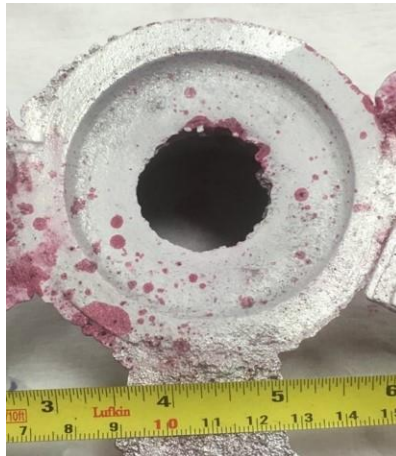
Figura 101. Método 2, END, tintas penetrantes, vista superior, escala 1:0.0125, polea
