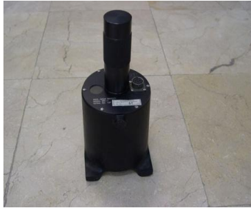
Fig.2 Sensor sísmico SS1 de KMI
