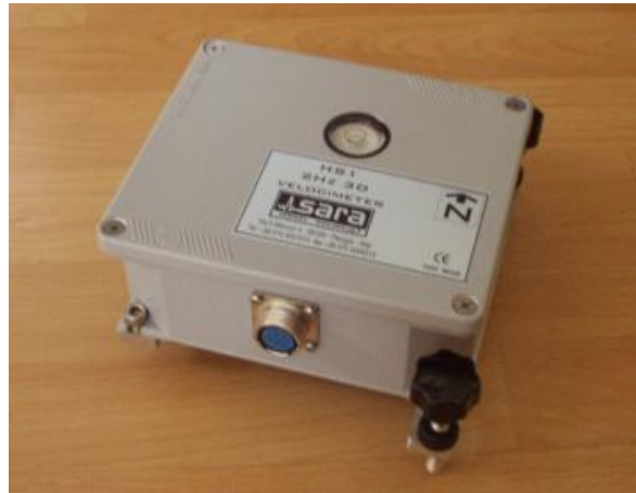
Fig18. Sismómetro triaxial de periodo corto de 4.5 Hz
