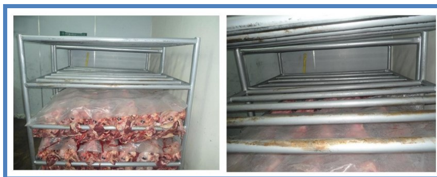
Figura N° 12: Estantes metálicos con oxido.
