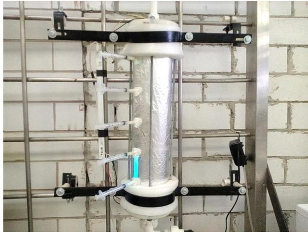
**Figura 11.3** Reactor fotocatalítico con puertos de muestreo en longitud axial
