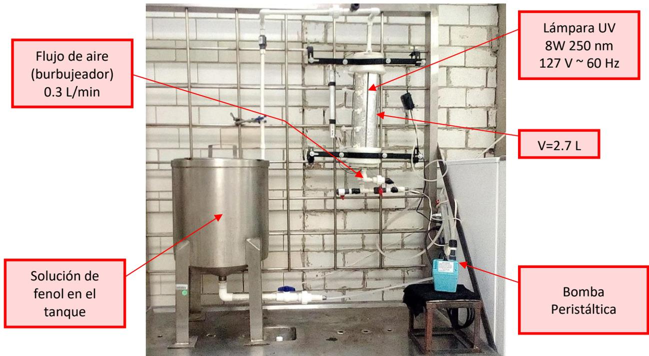
Figura 11.2 Diseño experimental
