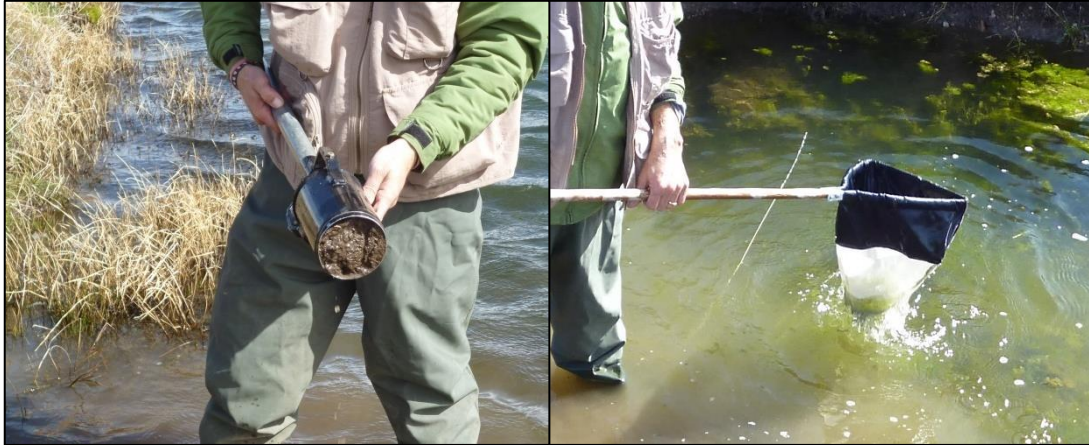
Figura 4.1: Métodos de colecta de macroinvertebrados. Izq: corer de 12 cm de diametro para bentos. Der: Red marco tipo D-frame para columna de agua.
