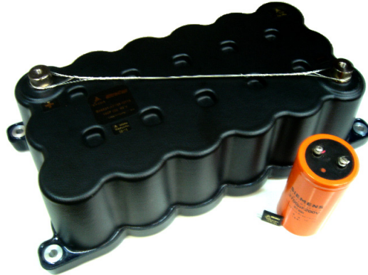
Figura 2.6: Foto ilustrativa do módulo supercapacitor EPCOS de 150 F e 42 V.
