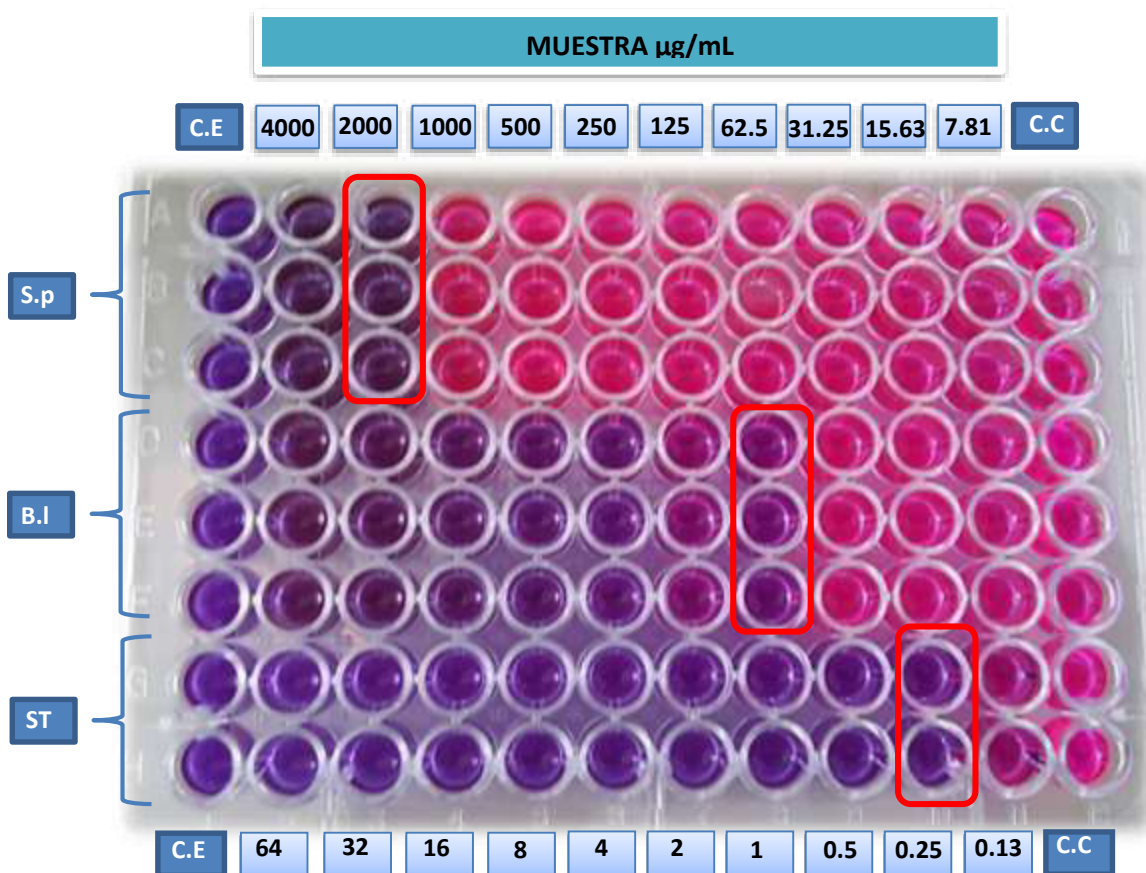
Figura 35. Determinación de la concentración mínima inhibitoria (CMI) de los extractos de Schkuhria pinnata (S.p), Baccharis latifolia (B.l) y estándar de eritromicina (ST) por el método de microdilución colorimétrica en microplaca frente a Staphylococcus aureus ATCC 25923, donde C.E. es control de esterilidad y C.C. es control de crecimiento.
