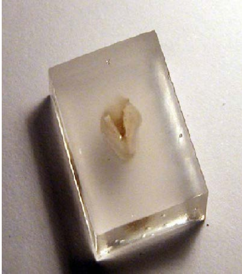
Fig.1.4- Corte de una pieza dentaria incluida en resina epóxica conformando el taco que será desgastado, pulido y metalizado.
