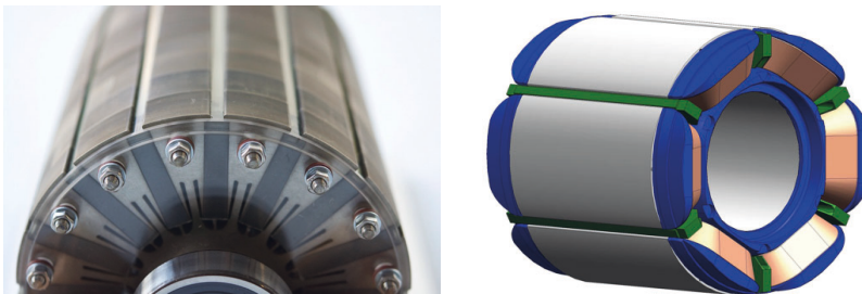
Abbildung 2-4: Detailansicht einer permanenterregten Synchronmaschine mit radial orientierten Magneten (links), Detailansicht einer fremderregten Synchronmaschine mit Elektromagneten (rechts) [70, S. 7]
