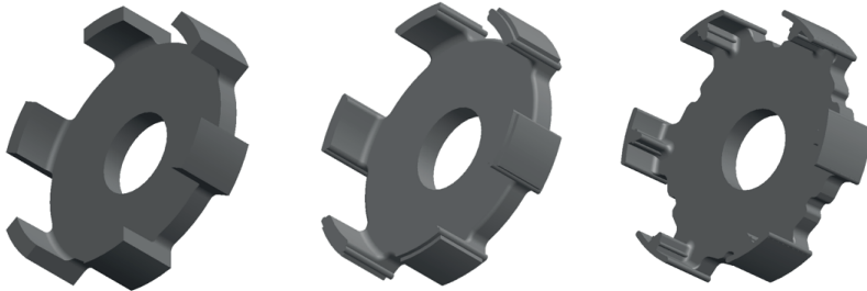
Abbildung 3-2: Geometrievariationen von Klauenpolmotoren v.l.n.r.: Konzept I: Klauenpolgrundkörper für optionale Bandagierung; Konzept II: Klauenpolgrundkörper für lokale Bandagierung; Konzept III: Klauenpolgrundkörper für Verguss und optionale Bandagierung
