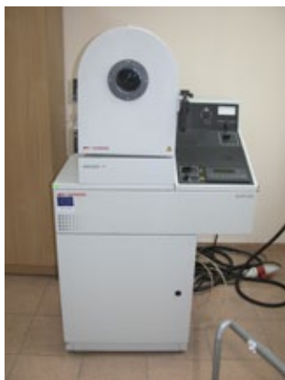
144 pav. Prietaisas pėdsakams ryškinti vakuume.
