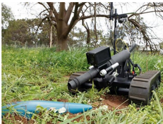
201 pav. Robotas, skirtas dirbti su sprogstamais įtaisais.
