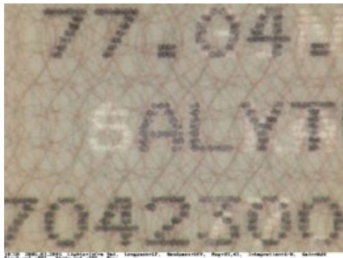
206 pav. Klastojimo ėsdinimo būdu požymis 327 .
