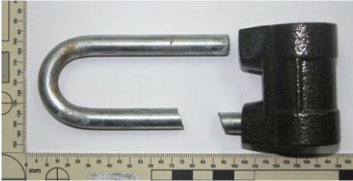
161 pav. Pakabinamoji spyna, įveikta perpjaunant jos lankelį 265 .
