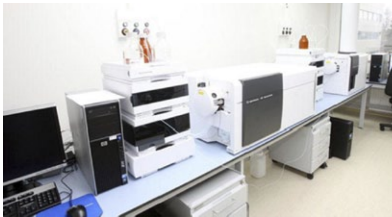
9 pav. VTMT Toksikologijos laboratorija Vilniuje – naujausia skystinės chromatografijos sistema su programine įranga (pagaminta JAV).
