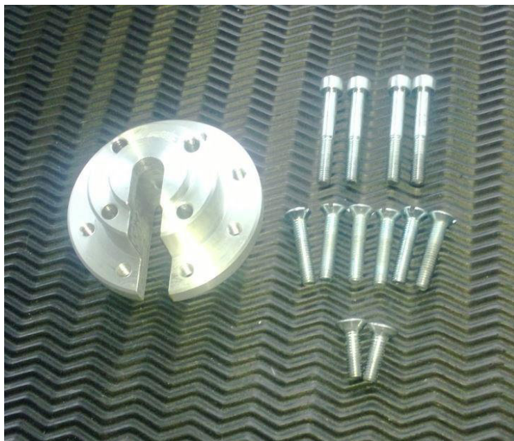
Abbildung 3: Adapterstück für die Radnabenmotoren
