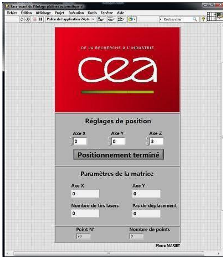
Figure 34 : Interface LabView pour le pilotage des platines de positionnement et du shutter.
