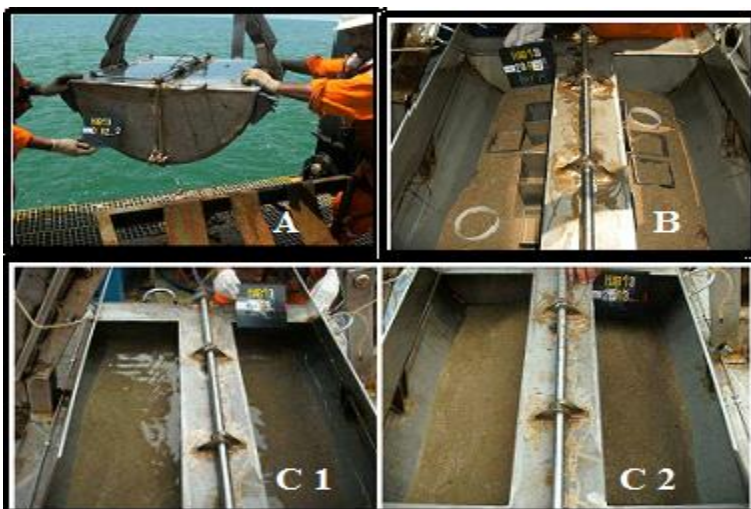
Figura 6.A) Busca-fundo do tipo van Veen utilizado nas coletas. B) Gabaritos inseridos no sedimento coletado. C 1 e 2) Sedimento coletado sobre a plataforma continental da Bacia de Campos. Fonte: Relatório Técnico do Projeto HABITATS 13 (2009).
