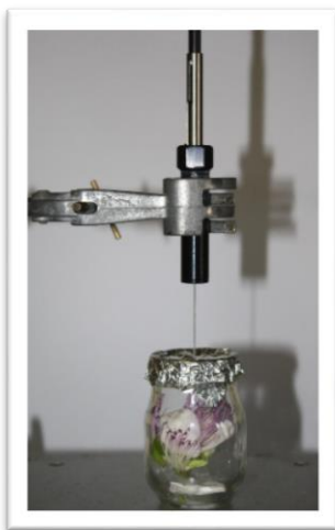
Contatto tra fibra adsorbente e spazio di testa
