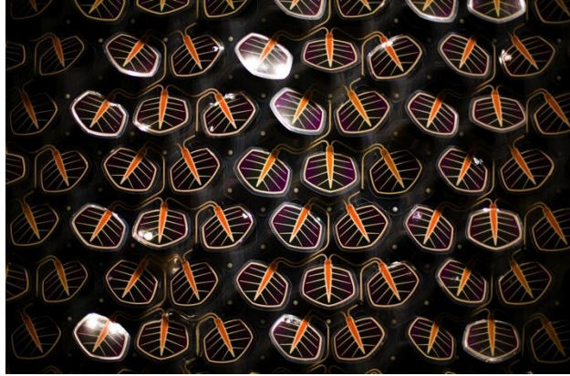
Figure 8 Samuel Cabot Cochran, Grow, 2005. Sistema che combina sottili film fotovoltaici e un sistema piezoelettrico che converte l'energia eolica.
