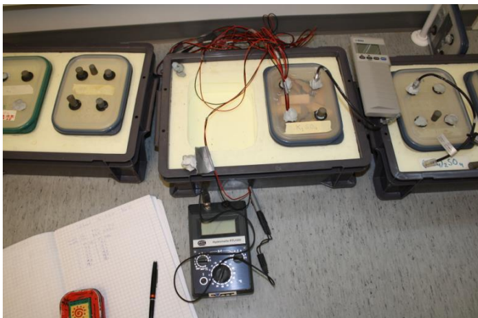
Kuva 22. Kosteusmittareiden kalibrointi suoritettiin käyttäen hyväksi kylläistä suolaliuosta, joka sijaitsi suljetussa astiassa. Kuva 23. Kosteusmittausten lukulaitteena käytettiin Gann RTU-600 kosteusmittalaitetta.
