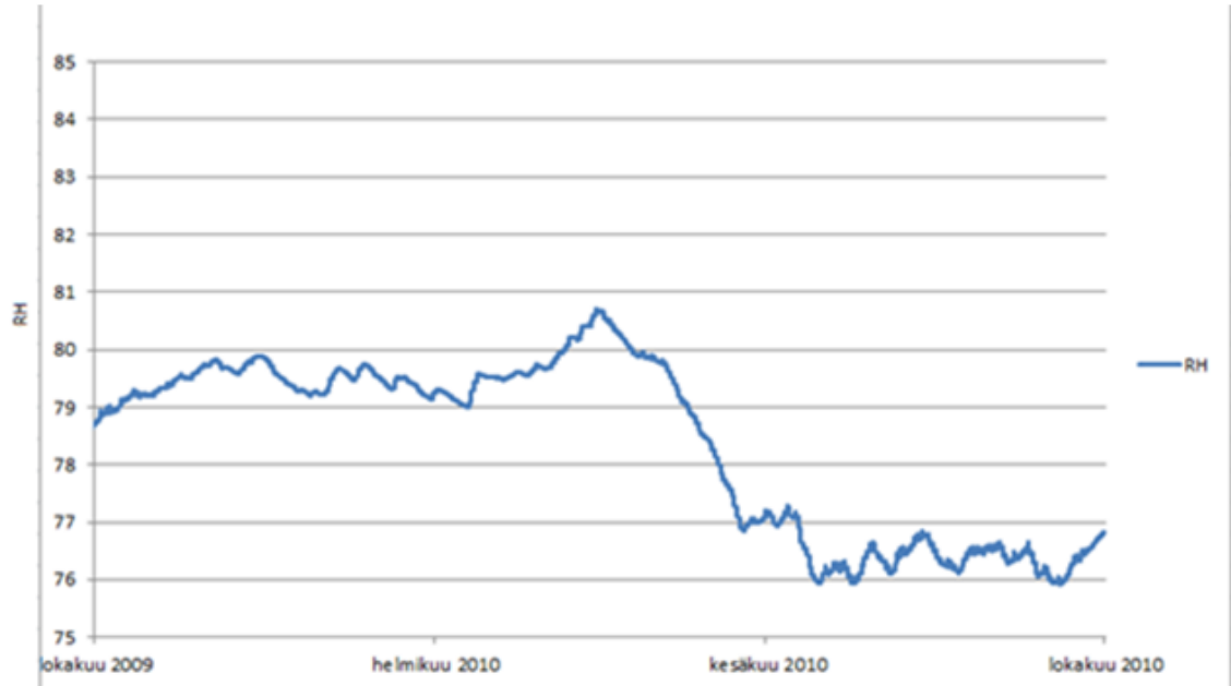
Kuva 52. Kuvaaja esittää alajuoksun suhteellisen kosteuspitoisuuden etelän puolella. Alajuoksun alla on bitumisively ja rakennetta kuormittaa viistosade rasisus.
