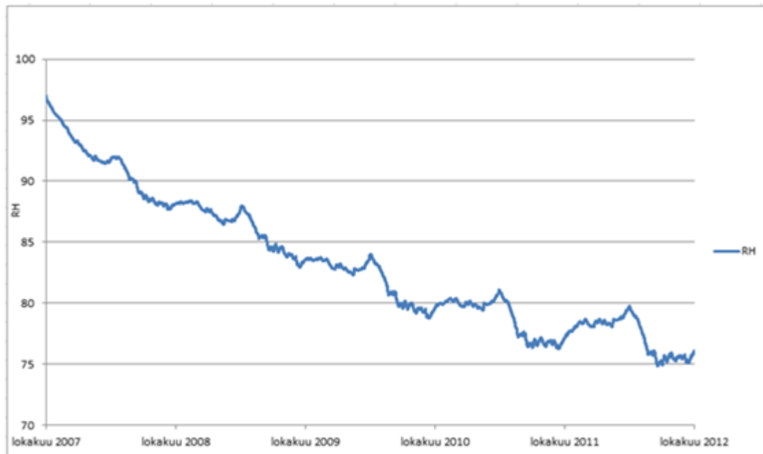
Kuva 65. Alajuoksun yläpinnan kosteuspitoisuus. Rakenteessa ei ole bitumisivelyä, rakenteeseen vaikuttaa viistosaderasitus
