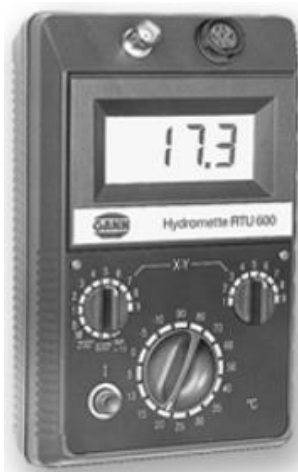
Kuva 22. Kosteusmittareiden kalibrointi suoritettiin käyttäen hyväksi kylläistä suolaliuosta, joka sijaitsi suljetussa astiassa. Kuva 23. Kosteusmittausten lukulaitteena käytettiin Gann RTU-600 kosteusmittalaitetta.
