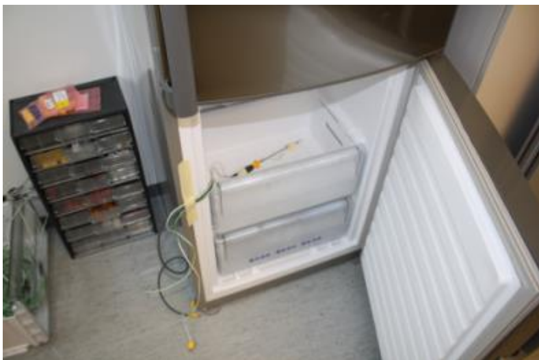
Kuva 24. Termoelementit kalibrointiin pakastimessa, jääkaapissa ja huoneen lämmössä.
