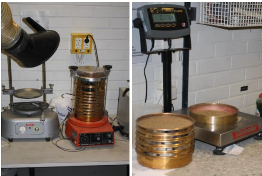
Kuva 33. Seulonta suoritettiin Oulun yliopiston geologianlaitoksen laboratoriossa. Apuna seulonnassa käytettiin Fritsch-tärypöytää ja elektronista vaakaa.
