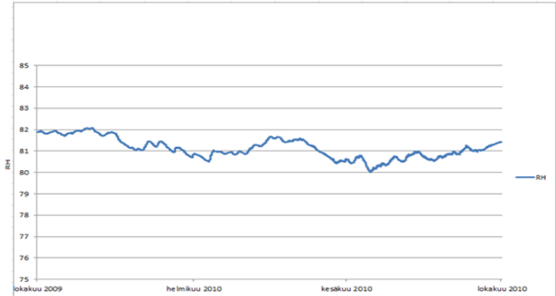
Kuva 57. Alajuoksun yläpinnan kosteuspitoisuus. Alajuoksun alla ei ole bitumisivelyä ja rakennetta kuormittaa viistosaderasitus.
