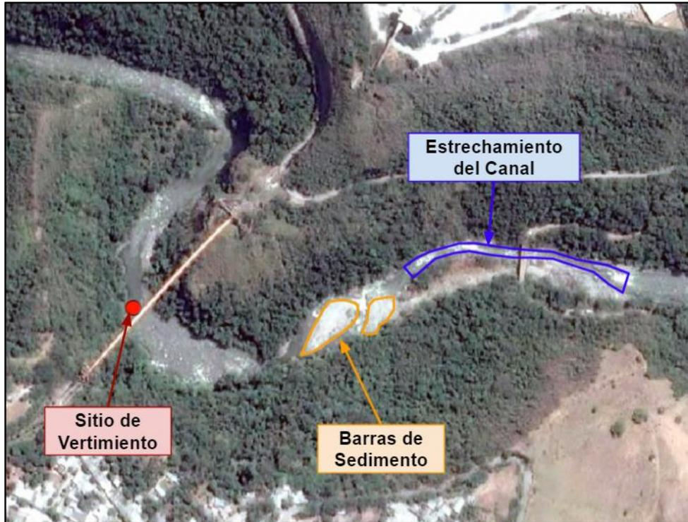
Figura 41. Generación de barras de sedimento por el cambio de sección del cauce del río Coello.
