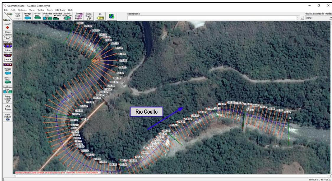
Figura 25. Ubicación de las secciones de cálculo, levantadas e interpoladas, en la GUI del modelo.
