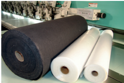
Stickunterlagen stabilisieren den Stoff.
