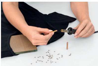
1 Die Pickerspitze des Applikators ist entsprechend der Kristallgröße so zu wählen, dass sich der Kristall nicht verkanten kann. Alternativ kann eine flache Pickerspitze verwendet werden.
