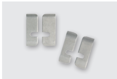
Durch Aufkleben von Metallplättchen (erhältlich bei Swarovski) kann ein adaptierter Nähfuß hergestellt werden.
