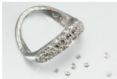
XILION Chatons, die mit einem Standard-Epoxidharzklebstoff verklebt wurden, fallen aufgrund der geringen Schockabsorbierung (ca. 10%) bei extremen mechanischen Belastungen aus der Kavität.
