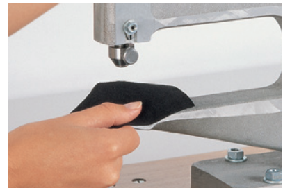
3 An der zuvor markierten Stelle auf das Textil applizieren. Einpresstiefe bzw. Druck mit Hilfe des verstellbaren Anschlags regulieren.
