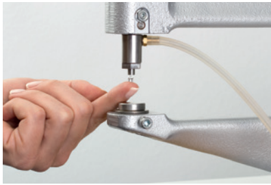
1 Einsetzen des Pins in das obere Werkzeug.
