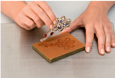
4 Nach Härten der Masse kann das Urmodell entnommen werden.
