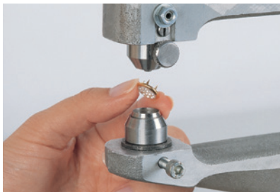
1 Decorative Button bzw. Oberteil des Snap Fasteners mit den Krallen nach oben in das untere Werkzeug einlegen.
