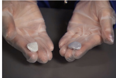
2 Beide Komponenten abwägen. Das Mischungsverhältnis für Ceralun ist 1:1 nach Gewicht.
