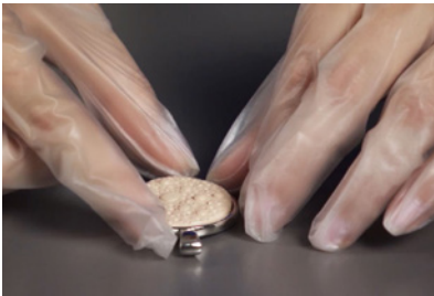
4 Nach kurzer Liegezeit im Tiefkühlfach kann das Ceralun der Form entnommen und auf dem ausgewählten Objekt platziert werden.
