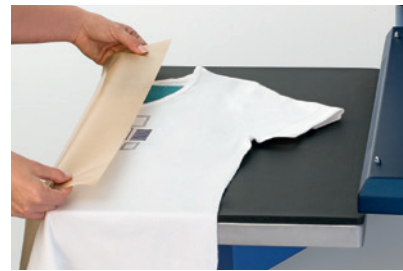
3 Auf die empfohlene Applikationsseite achten und die richtige Bügelhilfe verwenden. Um die Bügelflächen vor möglichen Kleberrückständen zu schützen, sollte eine Teflon® Folie verwendet werden.
