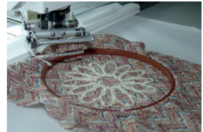
Der Spannrahmen dient beim industriellen Stickten zur Stabilisierung von dünnen und elastischen Stoffen.
