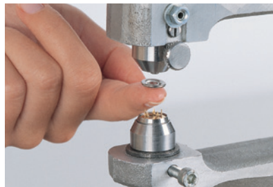
2 Federteil in das obere Werkzeug stecken.
