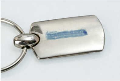
2 Bleibt die Tinte für zwei Sekunden sichtbar, eignet sich die Oberfläche für die Arbeit mit Ceralun.
