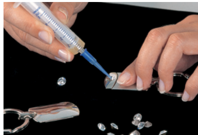
2 Den Klebstoff mit einem Dispenser auftragen.
