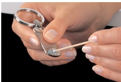
4 Den Kristall vorsichtig in die vorgegebene Kavität einlegen und leicht andrücken; Nachreinigung und Aushärten.
