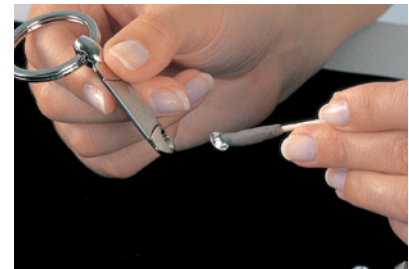
3 Den Kristall aufnehmen, z. B. mit einem Wachsstift.
