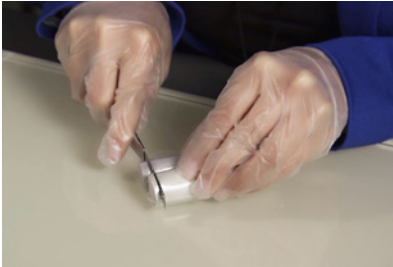
1 Jeweils ein Stück Harz und Härter mit einem Messer abschneiden.
