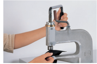
3 Applikation an der gewünschten Stelle durchführen. Einpresstiefe bzw. Druck mit Hilfe des verstellbaren Anschlags regulieren.
