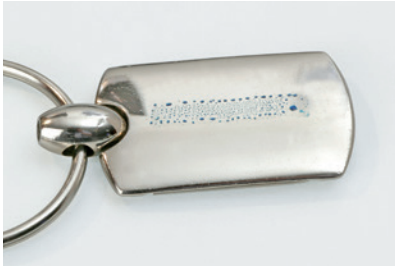
3 Verschwindet die Tinte oder bildet sie Blasen, ist die Oberfläche nicht als Träger für Ceralun geeignet. In diesem Fall müssen die Vorreinigungsmethoden überprüft werden.
