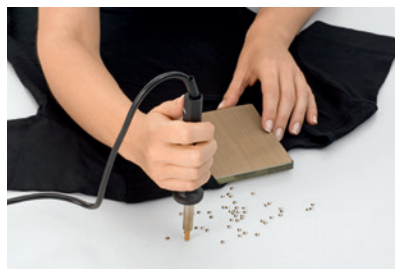
2 Den Applikator auf eine geeignete Temperatur erhitzen und die Kristalle aufnehmen.
