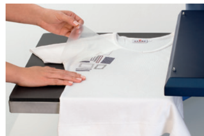
6 Wenn das Produkt handwarm oder kühler ist, kann die transparente Trägerfolie in einem spitzen Winkel abgezogen werden.
