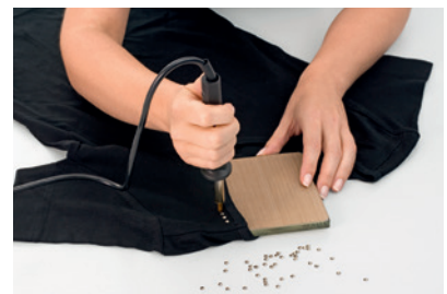
3 Sobald sich der Hotfix Klebstoff auf der Kristallrückseite verflüssigt, wird der Kristall auf dem Trägermaterial platziert. Dieses sollte auf einer festen Unterlage aufliegen (z. B. Glas, Metall).
