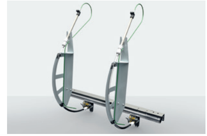
Ein Aufsatz wie der Lässer Crystal Stone Head für die Schiffl-Stickmaschine (oder das Lochrose Embroidery Device von Tajima) kann die Lochrose Art. 3129 vollautomatisiert applizieren.
