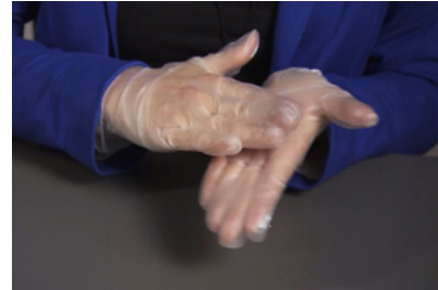
3 Harz und Härter vermischen bis eine homogene Masse entsteht.
