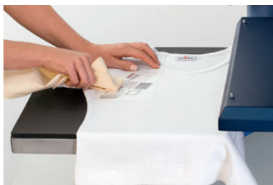
5 Nach Entnahme aus der Bügelpresse sollte das Produkt mit Hilfe eines Bügeltuchs zusätzlich (vorsichtig) angedrückt werden.
