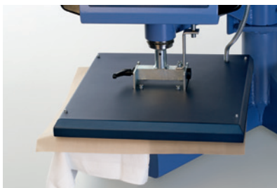
4 Nach Einstellen von Druck, Zeit und Temperatur wird die Bügelpresse geschlossen.
