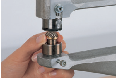
1 Oberteil des Jeans Buttons in das obere Werkzeug einlegen.
