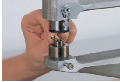
2 Pfeilnagel in das untere Werkzeug einlegen.
