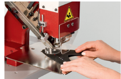
3 Einlegen des Trägermaterials und Applikation.
