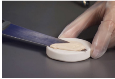
2 Überstehendes Material kann mit einem Messer entfernt werden.
