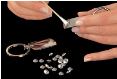
1 Die Oberfläche muss vor dem Kleben entsprechend vorbereitet werden (z. B. Reinigen, Entfetten, Strahlen).
