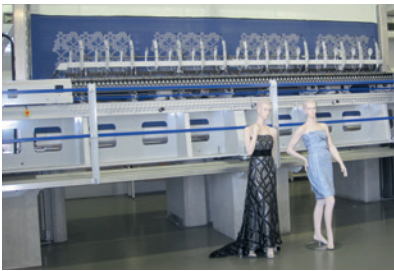
4 Vollautomatischer Stickvorgang mit einem System wie dem Lässer Crystal Stone Head (im Bild) oder dem Tajima Lochrose Embroidery Device.
