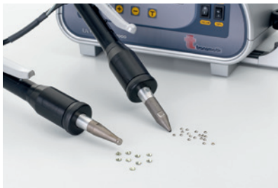
1 Den Adapter der Kristallgröße entsprechend wählen.
