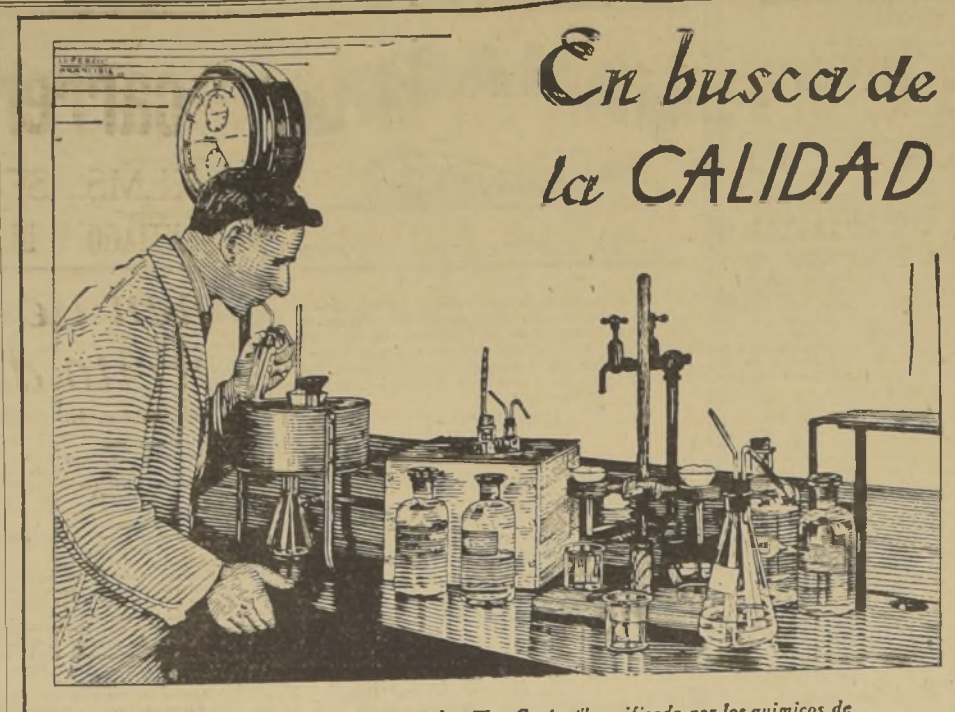
La ilustración corresponde a la prueba "Wax Content" verificada por los químicos de Shell para determinar y medir la cantidad de "esperma" contenida en los lubricantes.
