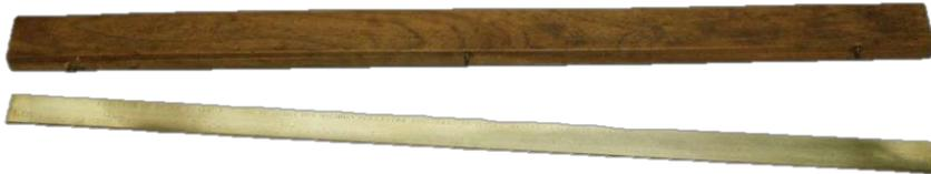
Etalon prototype du mètre en platine
