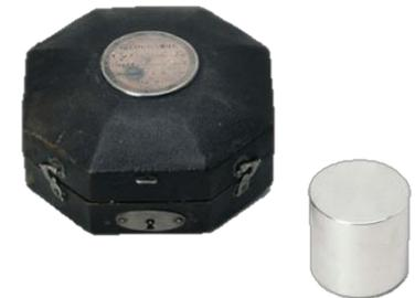
Etalon prototype du kilogramme en platine
